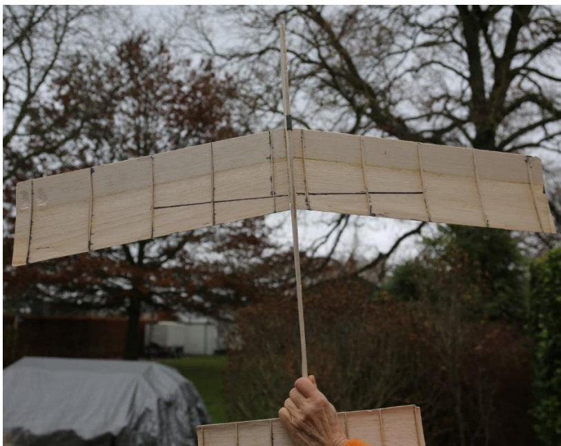
Ph-2 La position du CG est tracée à partir de la corde moyenne
