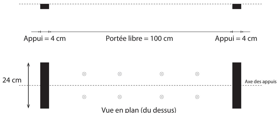
Figure 1 : Vue en plan et en élévation des appuis.
